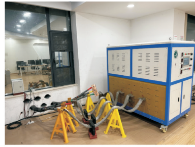
(a) 大电流发生器及三芯电缆终端头
